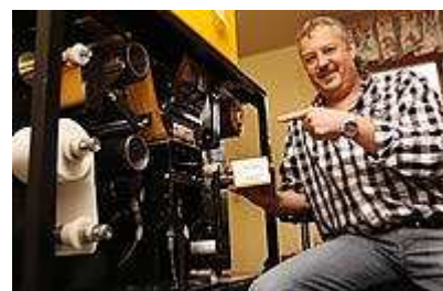
Fritz und Edeltraud Loibl stellen seit 2008 veredeltes Toilettenpapier her. Die Bayerwaldler haben sich ihre Erfindung europaweit patentieren lassen. Mit einem befreundeten Maschinenbauer hat Fritz Loibl eine spezielle Maschine entwickelt (oben): Im Heißprägeverfahren wird die beschichtete Folie oder das Echtgold auf die Rollen aufgetragen. – Fotos: Haydn
